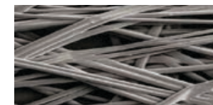
Структура геотекстиля «Тура». Однородность структуры по всему полотну определяет отсутствие мест с высокой плотностью, хуже пропускающих воду
